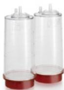
Набор **Steritest EZ** с красными канистрами для контроля стерильности антибиотиков и препаратов с противомикробным действием.
