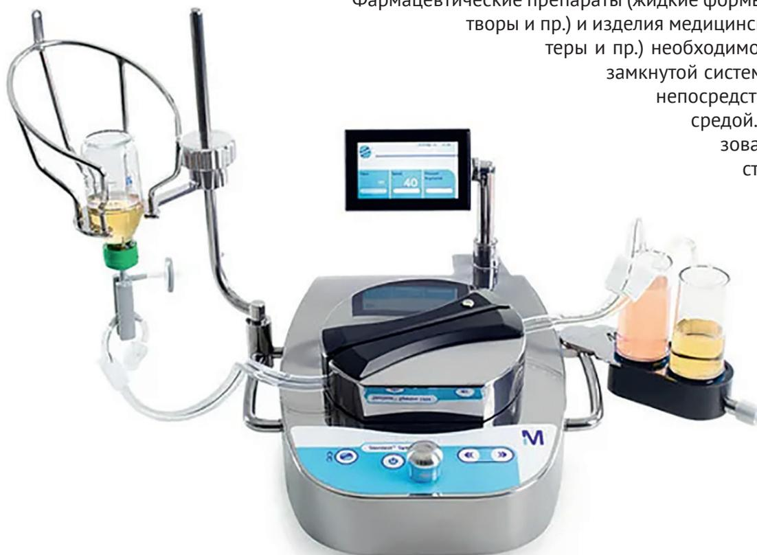
Фармацевтические препараты (жидкие формы, порошки, мази, масляные растворы и пр.) и изделия медицинского назначения (шприцы, катетеры и пр.) необходимо испытывать на стерильность в замкнутой системе, полностью исключающей их непосредственный контакт с окружающей средой. Именно такой принцип реализован в **Steritest Symbio** производства компании **Merck (Millipore)**.
