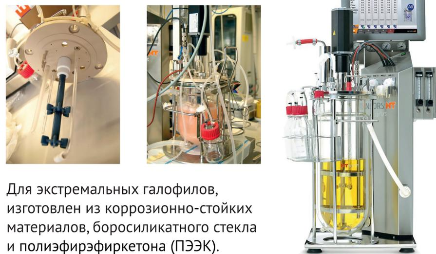
Для экстремальных галофилов, изготовлен из коррозионно-стойких материалов, боросиликатного стекла и полиэфирэфиркетона (ПЭЭК).
