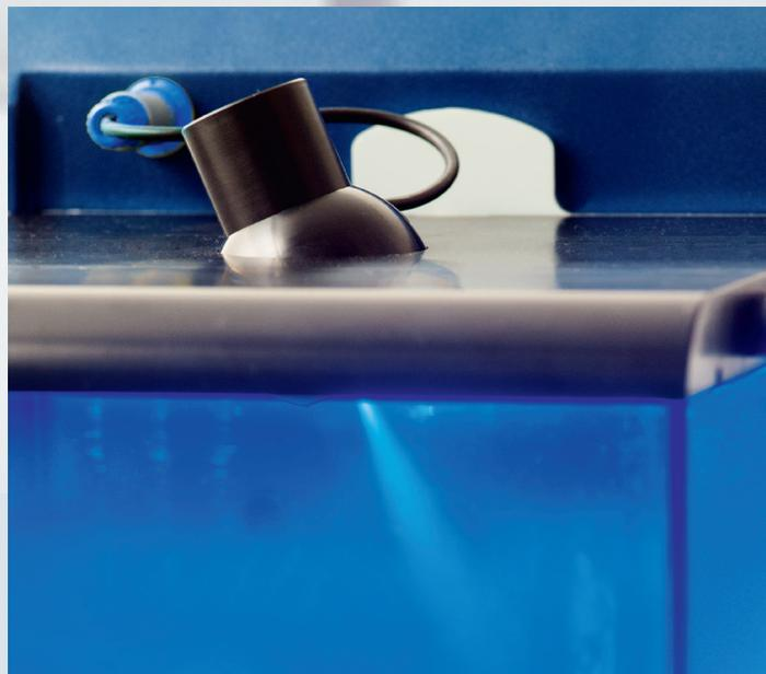
Головка генерирует чрезвычайно тонкий реагентный туман, который равномерно распределяется в камере, и постепенно конденсируется на ТСХ/ВЭТСХ пластине.
