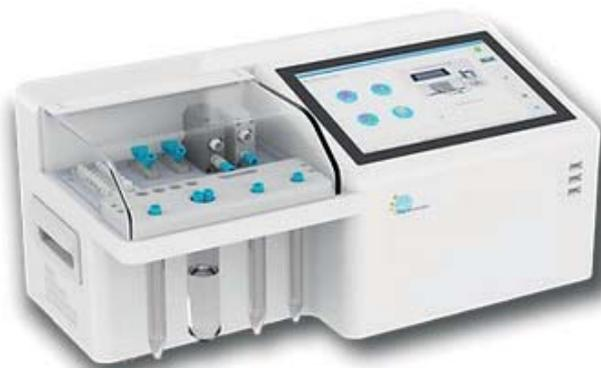
**NGe Flex-M** обеспечивает широкий диапазон пропускной способности от 1 до 12 мл за запуск, что позволяет произвести большее количество эмульсии, достаточное для проведения скрининговых исследований. Возможность установки соотношений фаз в диапазоне от 2:1 до 5:1 позволяет оптимизировать параметры системы для генерации частиц с точно заданными размерами.
