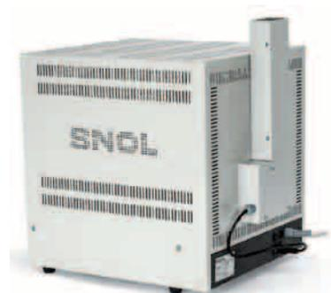
**Электропечь SNOL с системой вытяжки продуктов сгорания**
