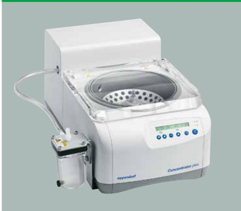
Концентратор Concentrator plus обеспечивает быстрое, эффективное и бережное вакуумное концентрирование ДНК/РНК, нуклеотидов, белков, пептидов и других жидких или влажных образцов.
