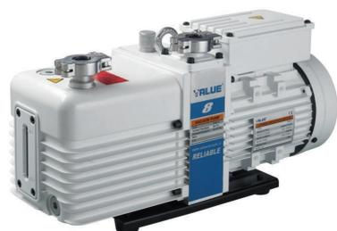
**Двухступенчатый пластинчато-роторный вакуумный насос** с низким уровнем шума, высоким значением вакуума и высокой эффективностью откачки. Специальная конструкция гарантирует надежную защиту вакуумной системы от загрязнения после остановки. Для повышения коррозионной стойкости и предотвращения утечки масла в насосе используются сальниковые уплотнения из фторопласта. Использование высококачественного масла для вакуумных насосов позволяет увеличить срок службы оборудования.
