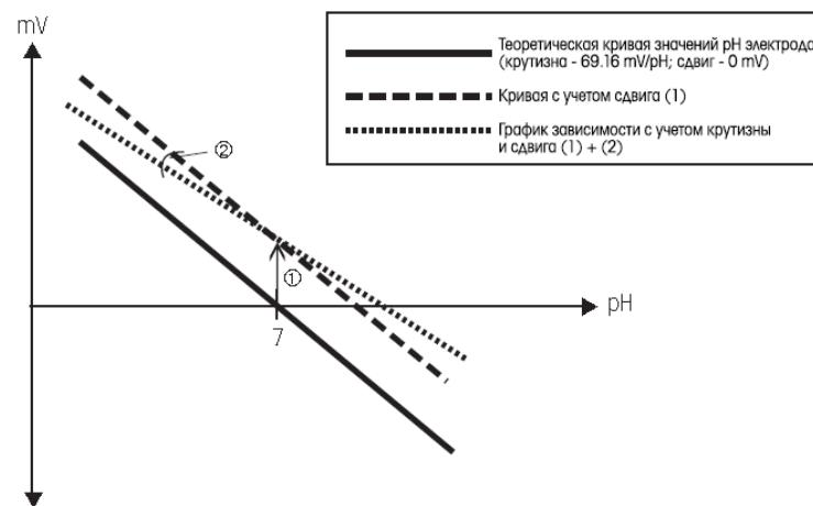
Рис. 2. Связь между величиной мВ, измеренным рН-электродом, и уровнем рН в образце. Показаны теоретическая кривая, кривая с компенсацией сдвига и кривая с компенсацией крутизны и сдвига.
