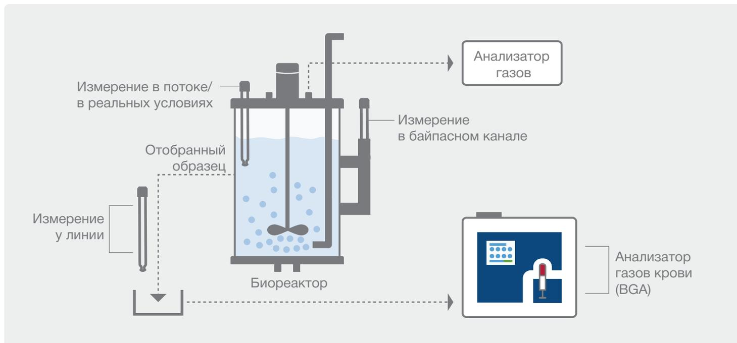
Рис. 1 Различные методы мониторинга параметров процесса, разрешенные директивой по PAT (2004 г.)<sup>1</sup> и рекомендуемые в современной научно-технической литературе.<sup>3</sup>
