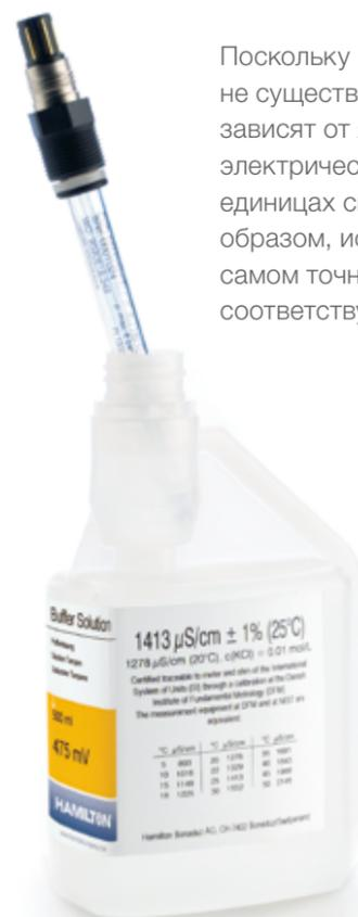
Поскольку в диапазоне низкой проводимости не существует первичных эталонов, измерения зависят от ячеек абсолютных измерений, в которых электрическая проводимость отслеживается в единицах системы СИ; метрах и вольтах. Таким образом, испытания эталонов Hamilton выполнены на самом точном измерительном устройстве в мире с соответствующей сертификацией.
