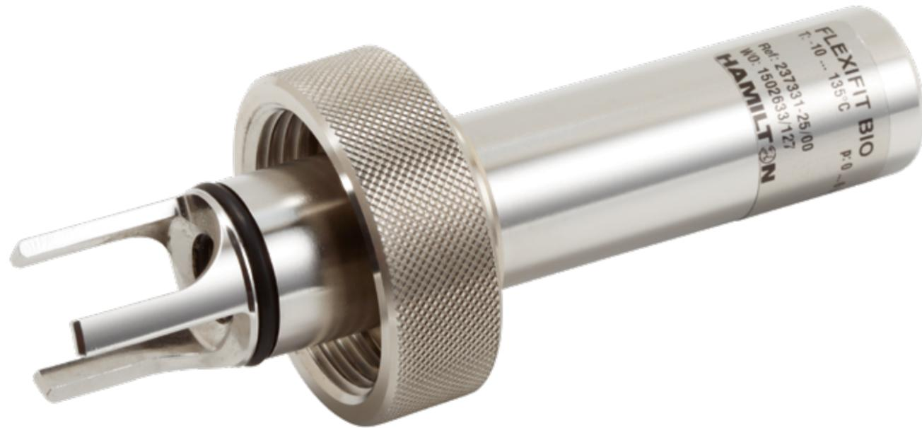
Держатели FlexiFit разработаны под датчики 120 мм для применения в различных отраслях промышленности. Различные виды подсоединений обеспечивают удобство использования в химической промышленности, а также в процессах, где требуется соблюдение гигиенических требований. Все приспособления FlexiFit имеют уплотнительные кольца из EPDM, а качество электрополированной поверхности ( $R_a < 0,4$  мкм) отражено в сертификате. Подходят для безразборной мойки и стерилизации паром, а также автоклавирования.
