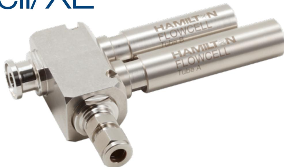
Проточные ячейки от Hamilton предназначены для измерения одного или двух параметров одновременно. Возможные комбинации датчиков: pH/DO и pH/Проводимость. Измерение производится в обводной линии, если монтаж в основную трубу невозможен из-за малых размеров трубы. Области применения – биотехнология, водоподготовка и электростанции, где надежные измерения должны проводиться в слабо проводящих средах. Доступны два разных размера проточной ячейки.
