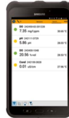
Это мобильное устройство позволяет оператору контролировать измеренные значения, калибровать датчики Arc и настраивать различные параметры с помощью единого пользовательского интерфейса для pH, DO, проводимости и ОВП. Мобильное устройство Arc View Mobile основано на планшете Samsung Galaxy Tab Active и поставляется с предустановленной поддержкой приложения ArcAir, приложения-блокиратора приложений, кабеля питания, руководства по эксплуатации и быстрого руководства Hamilton.
